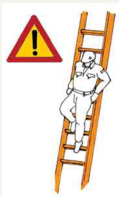
Esempio: erronea procedura di salita e discesa
