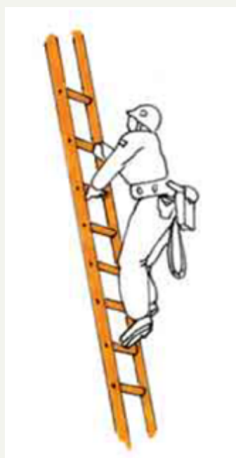
Esempio: corretta procedura di salita e discesa
